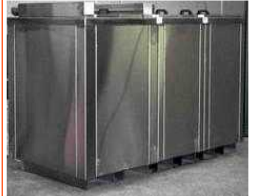
Impianto ad ultrasuoni per la finitura di materiali lavorati per idraulica, termotecnica, valvole gas, valvole pneumatiche ( in acciaio inox, in alluminio, in ottone) per acqua, per aria, per i gas, per il vapore saturo
